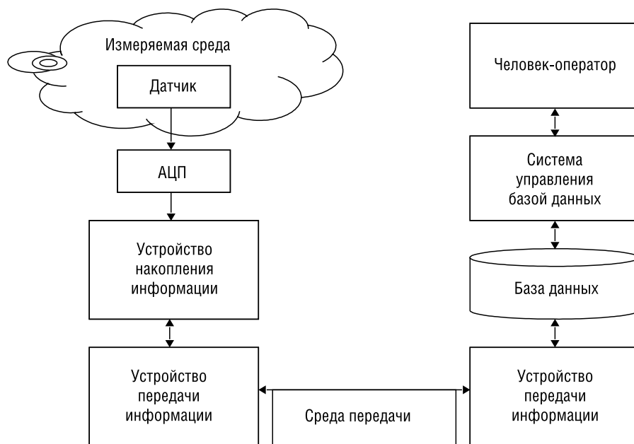
Рис. 1. Общая структура цифровой системы сбора, передачи, хранения данных
