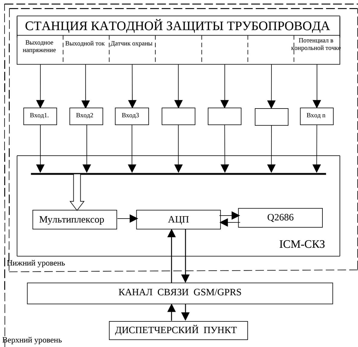
Рис. 3. Принцип действия ИСМ-СКЗ в составе подсистемы телеметрии АСДК
